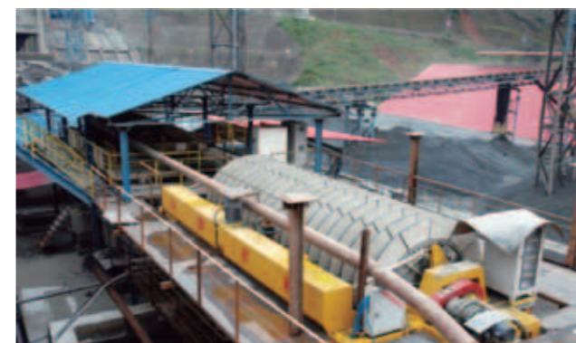
竹子坝砂石生产系统使用的陶瓷过滤器。
