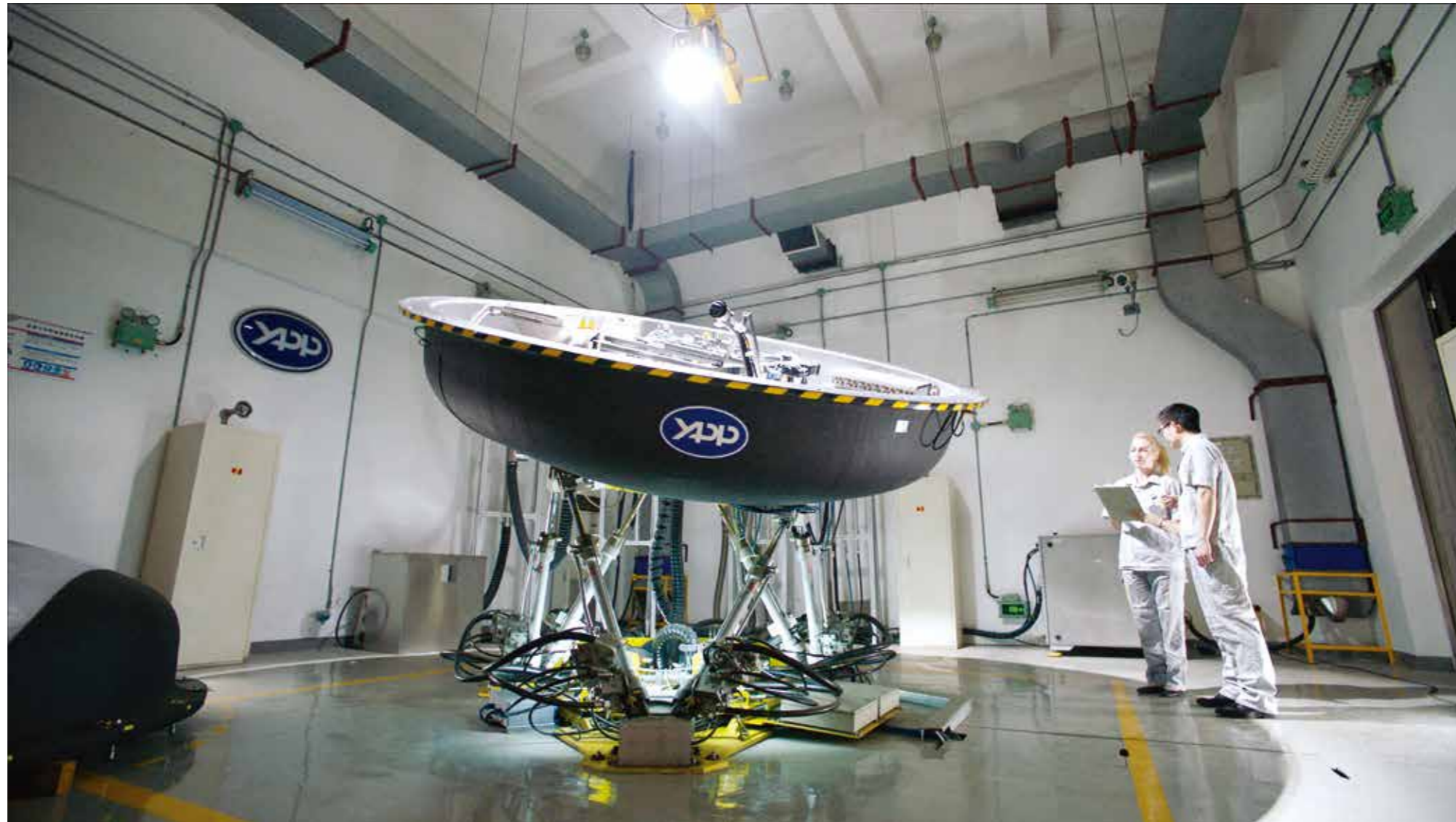
研发人员开展六轴动态模拟试验
